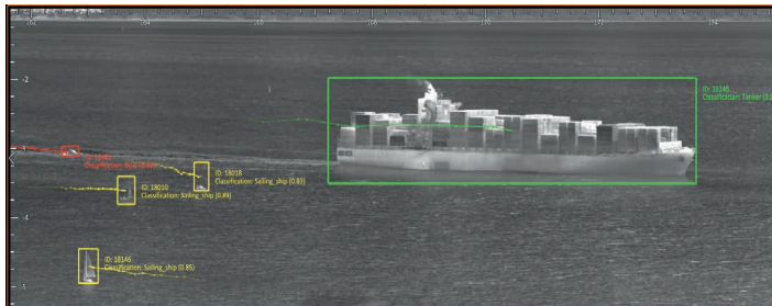
Classification automatique des navires basée sur l'Intelligence Artificielle GAIA™
