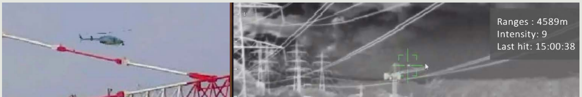
→ Poursuite automatique en mode «staring» avec option V-LRF sur Cyclope
