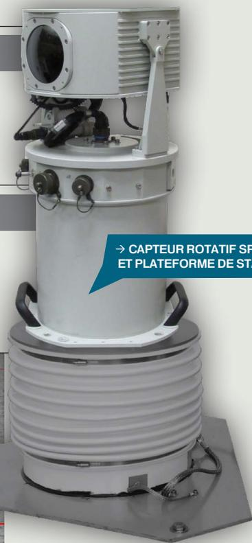
→ CAPTEUR ROTATIF SPYNEL-C ET PLATEFORME DE STABILISATION
