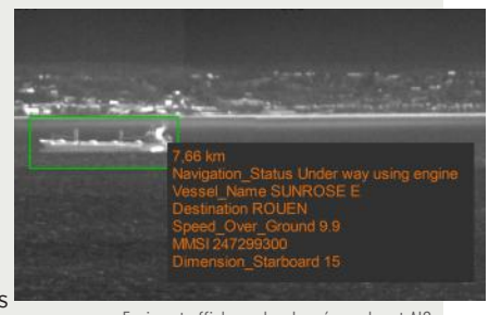
→ Fusion et affichage des données radar et AIS
