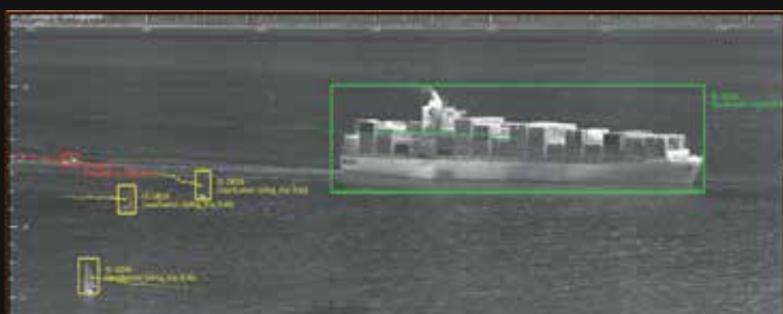
Classification automatique des navires avec l'Intelligence Artificielle GAIA
